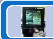
Quelli mobili sono installati a bordo di veicoli, permettono il rilevamento della velocità in modalità dinamica, ad inseguimento. Questi sono sempre utilizzati sotto il diretto controllo degli operatori di polizia.
