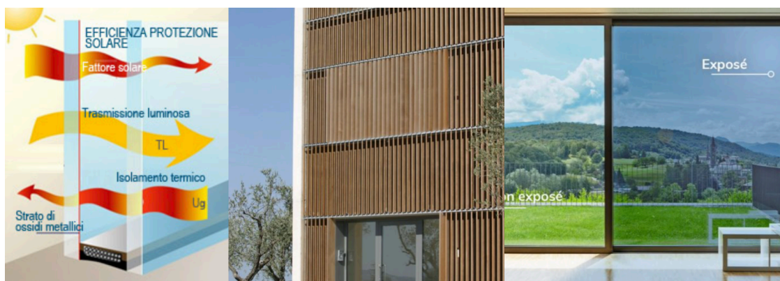
Schema di funzionamento dei vetri schermati ed esempi di realizzazioni possibili
