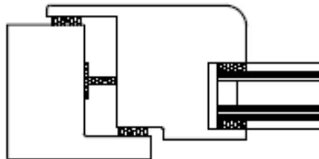
Occorre osservare che le norme UNI EN-N 12207 "Finestre e Porte – permeabilità all'aria – classificazione" e la UNI EN 12152 "Facciate continue permeabilità all'aria – requisiti prestazionali e classificazione" qualificano in base alla classe di tenuta all'aria il serramento stesso.
