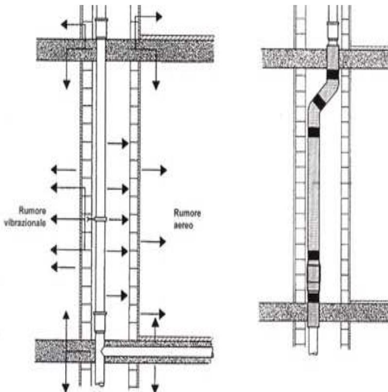
Per quanto riguarda le tubazioni di scarico orizzontali all'interno dei massetti, sarà necessario fare in modo che queste ultime attraversino unicamente locali quali bagni, ripostigli o corridoi, per non costituire un canale preferenziale di propagazione del rumore aereo nelle stanze di uso comune.
