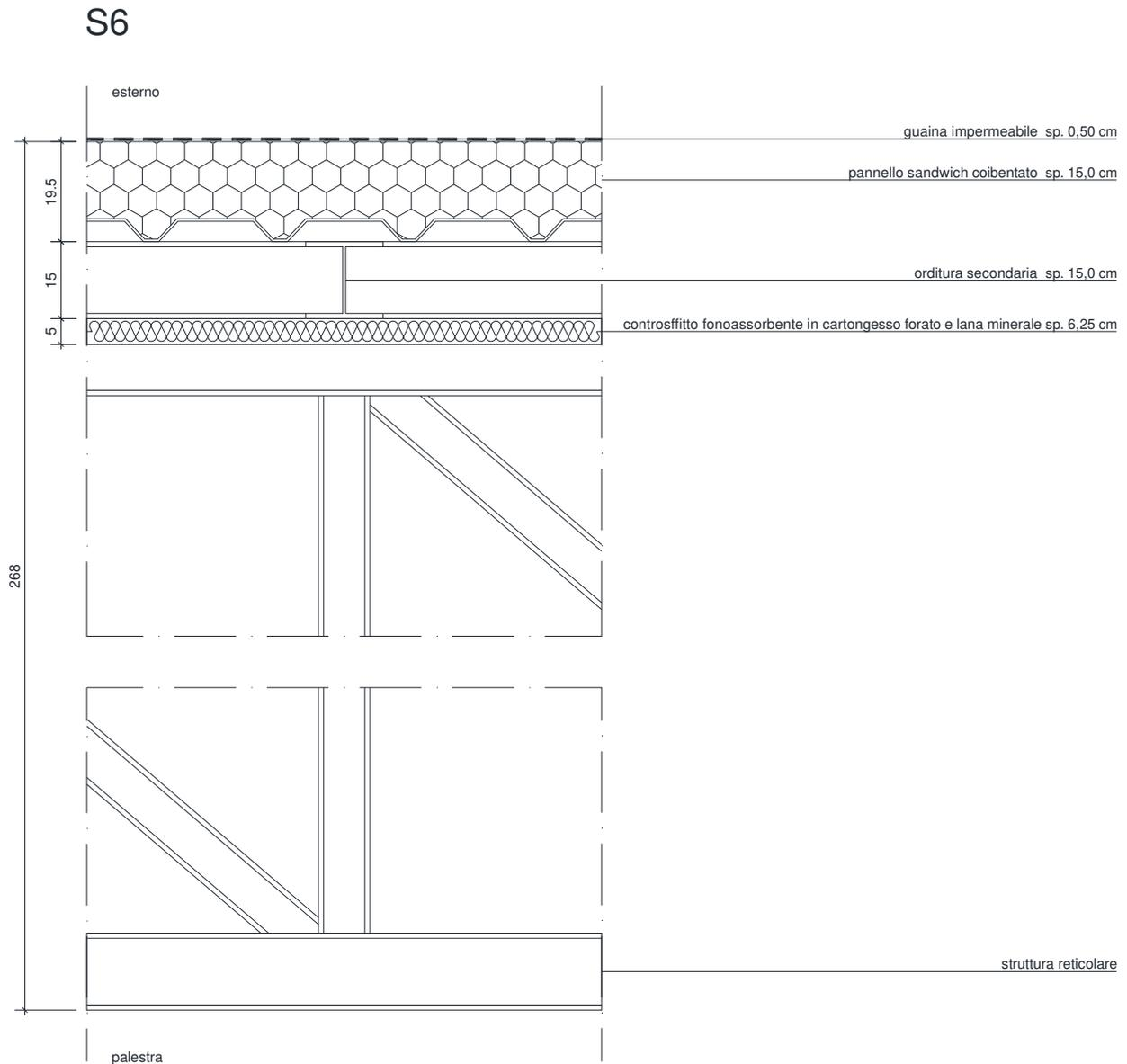
La presenza della guaina impermeabilizzante in estradosso contribuisce in modo sostanziale alla riduzione del rumore derivante da impatto di pioggia meteorica in quanto riduce la vibrazione del pannello coibentato.
