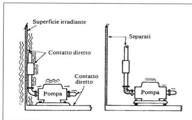
Il passo successivo è quello di rendere meno rigida la tubazione con l'inserimento di giunti elastici.
