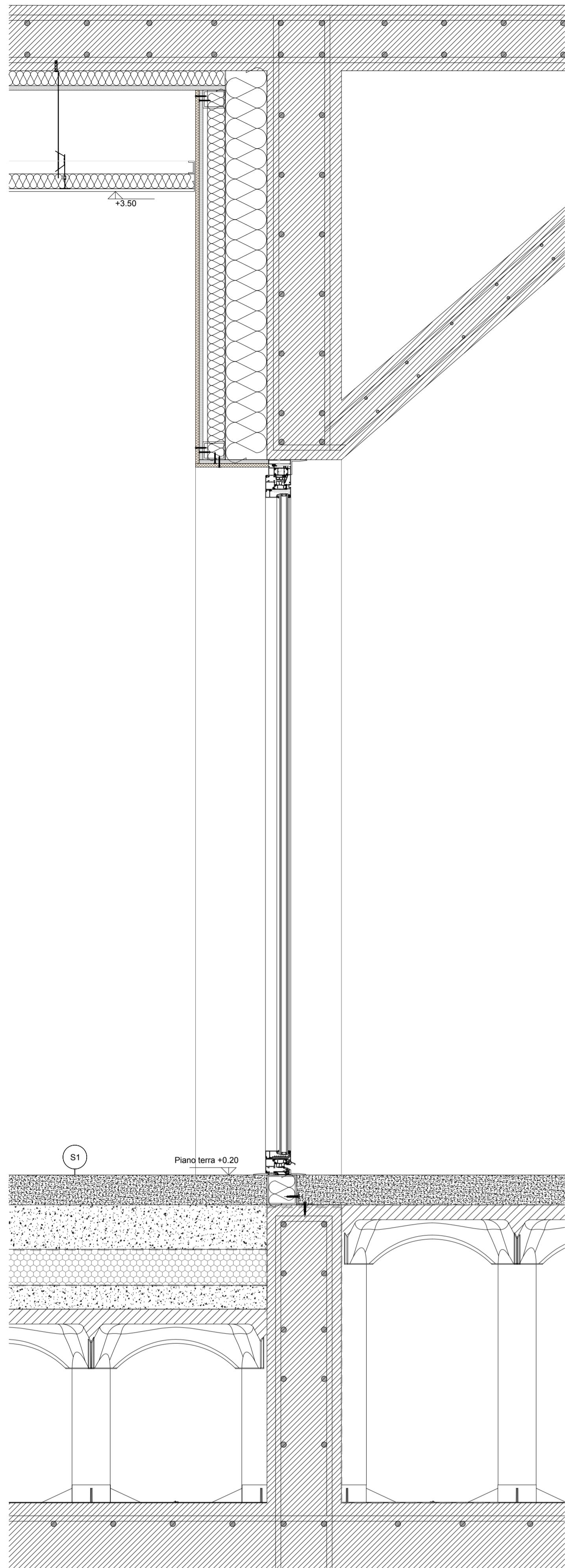
Sezione trasversale infisso tipo laboratori
