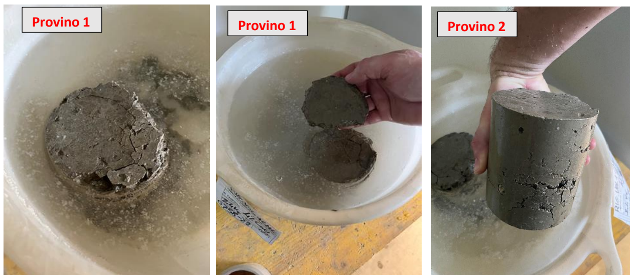
Foto dei provini MIX PZ + 4% CaO immersi in acqua per la determinazione del rigonfiamento volumetrico
