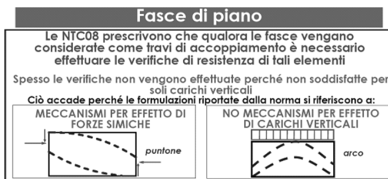
Figura 64 Comportamento fasce murarie sotto azione sismica e sotto carichi gravitazionali
