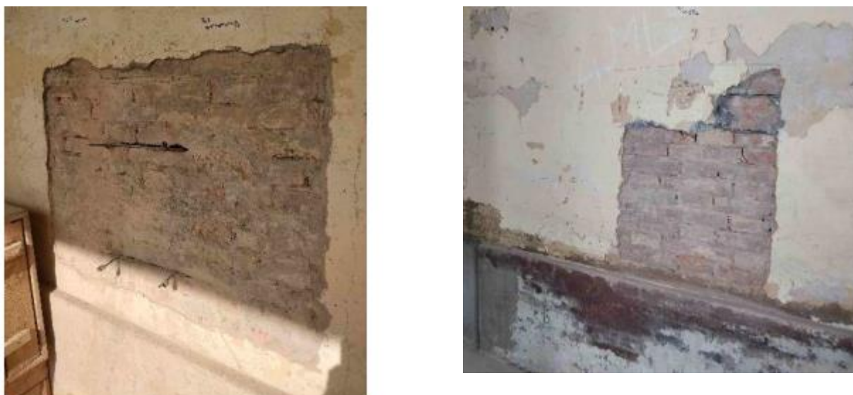
Figura 27 Prova di taglio diretto del giunto di malta: Shove test
