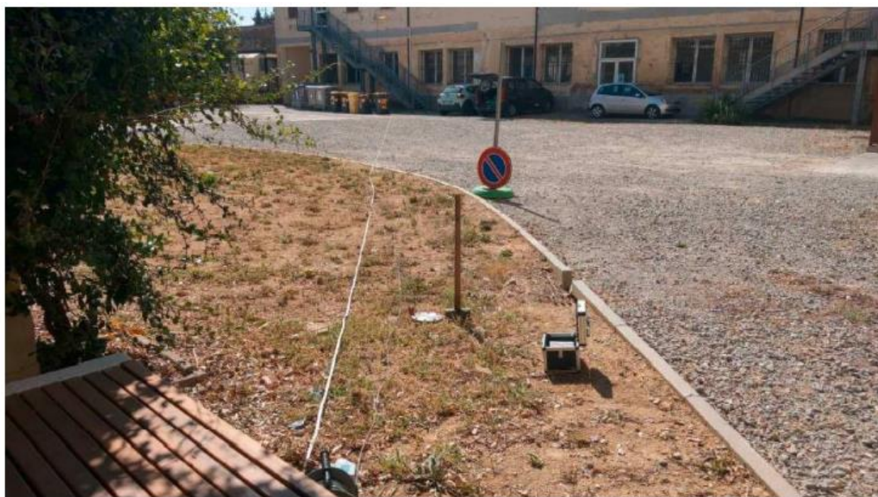
Figura 54 Esecuzione di prospezione SASW/MASW
