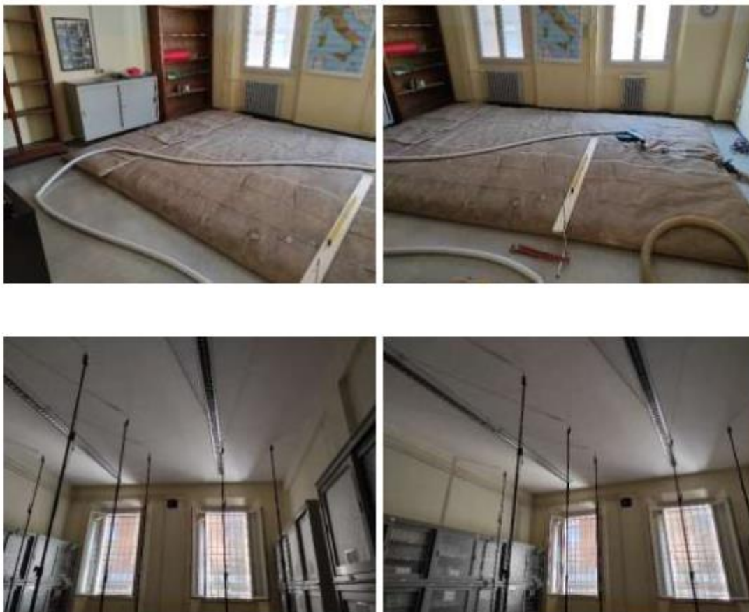
Figura 29 Prova di carico su solaio esistente
