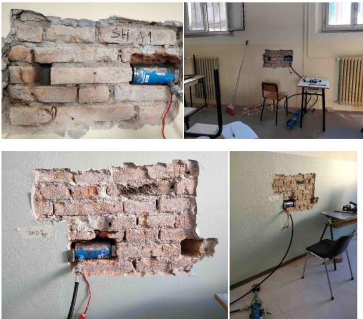
Figura 27 Prova di taglio diretto del giunto di malta: Shove test
