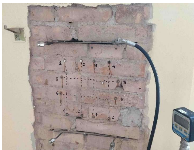
M.B.1 – Configurazione di prova e posizionamento prova
