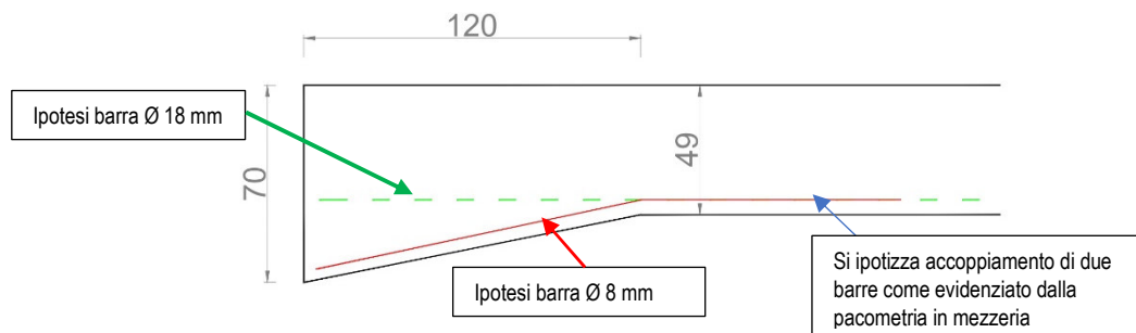
Dettaglio: dimensioni altezza della trave ed ipotesi posizionamento barre inferiori.
