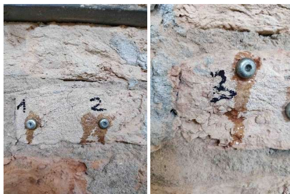
Fratture degli elementi durante l'esecuzione della prova.
