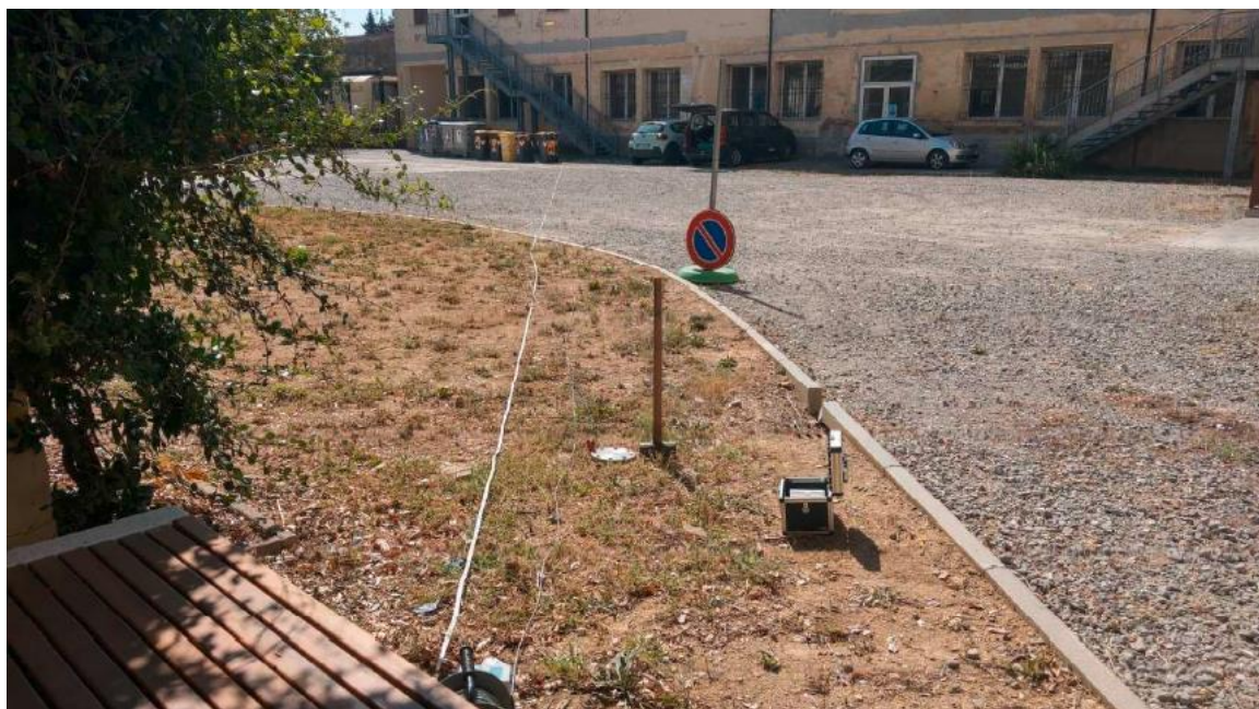
Esecuzione di prospezione SASW/MASW
