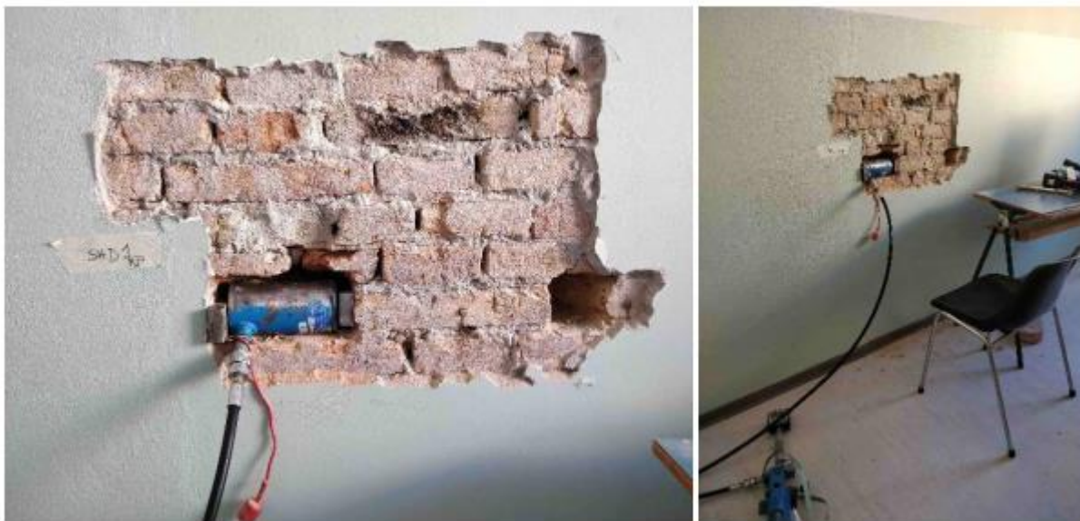
Figura 14 Prova di taglio diretto del giunto di malta: Shove test
