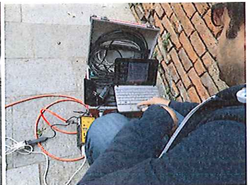
Foto 9,10,11 - Esecuzione di prova sismica ESAC (n° 2) : stendimento geofonico e acquisizione dati.
