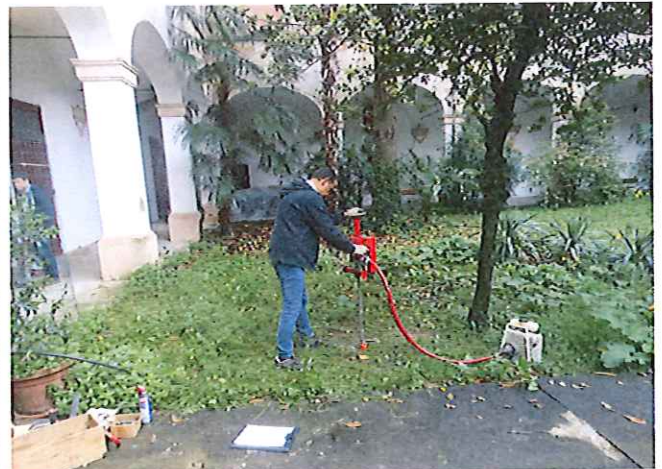
Foto 2- Esecuzione di prova penetrometrica DP1.
