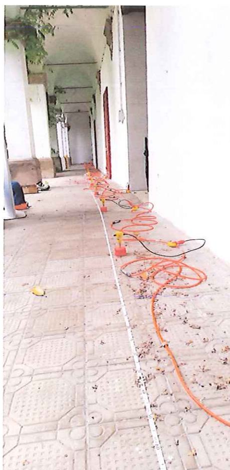
Foto 2: Linea sismica a 24 geofoni in onde P
