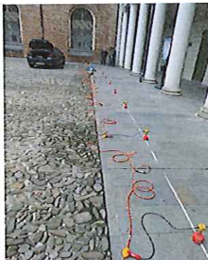
Foto 9,10,11 - Esecuzione di prova sismica ESAC (n° 2) : stendimento geofonico e acquisizione dati.
