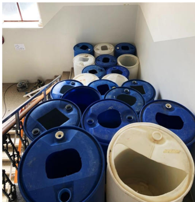
Figura 10: vista dei fusti disposti sulla parte d'opera da provare
