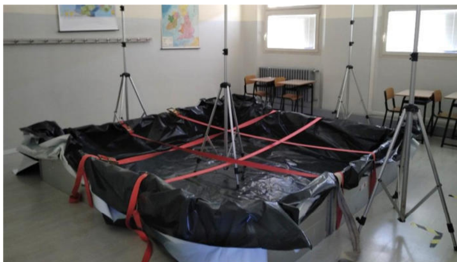
Figura 4: vista di una delle vasche impiegate per l'esecuzione delle prove di carico
