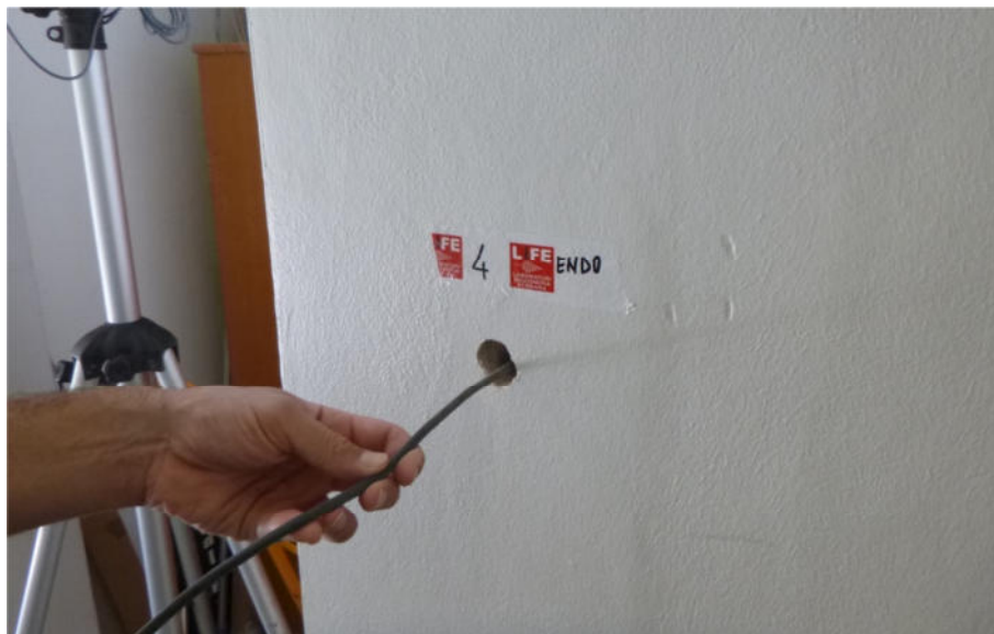
Figura 3: inserimento della sonda endoscopica e rilievo della successione stratigrafica
