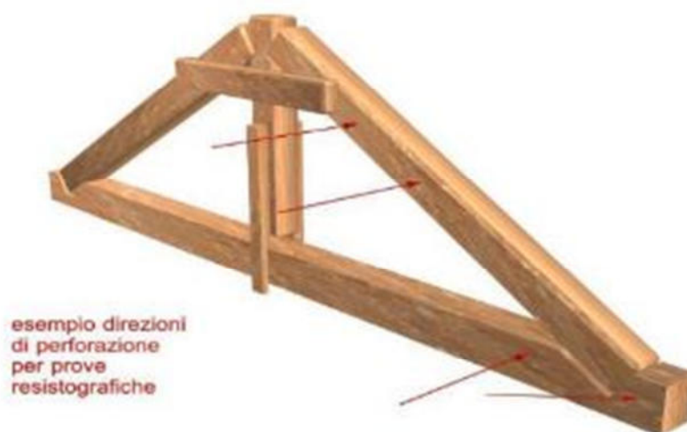
Figura 12: esempio di direzione di perforazione per prove resistografiche
