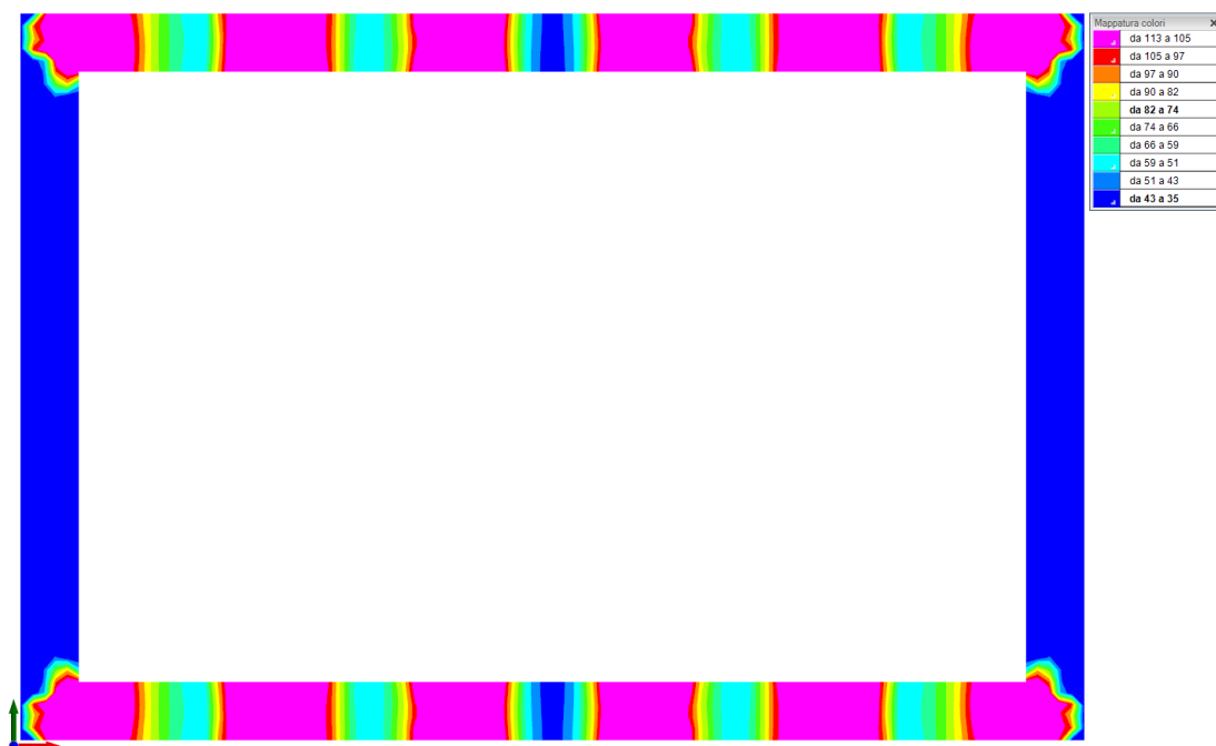
Figura 20. Involuppo Momenti Mxx massimi – Soletta in c.a. – Platea di Fondazione [kN*m/m]
