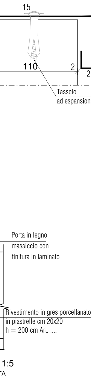
PARTICOLARE 2 - scala 1:5 SEZIONE - CHIUSURA DI TESTATA
