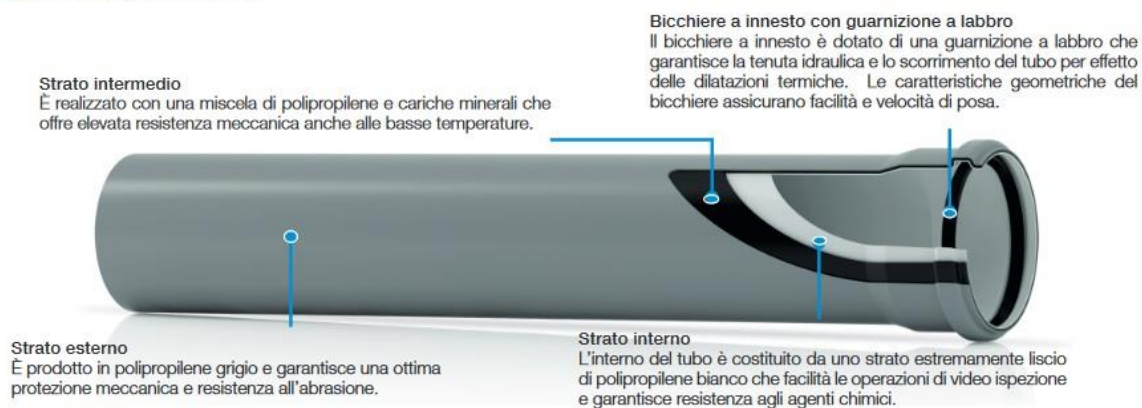
Figura Stratigrafia del tubo.
