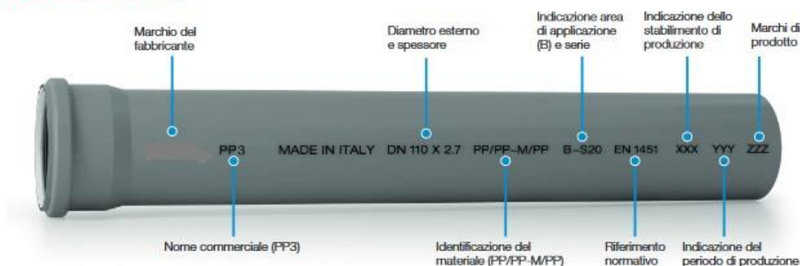
Figura Marcatura del tubo.
