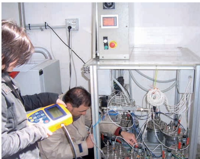
Figura 1. Reattori del Fermentatore di Laboratorio RES utilizzati nella sperimentazione.
